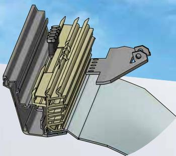
Konsole durch vorgestanztem Schlitz geschoben und verschraubt (SKT-Bohrschraube 6,3 x 25 bzw. SKT-Bohrschraube 4,8 x 25, DIN7504-K)
