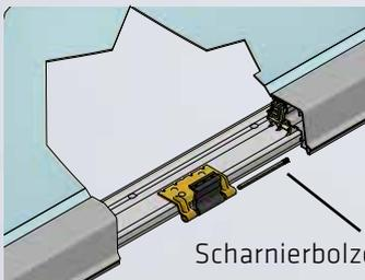
Scharnierbolzen mit Hammer einschlagen.
