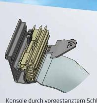
Konsole durch vorgestanztem Schlitz geschoben und verschraubt (SKT-Bohrschraube 6,3 x 25 bzw. SKT-Bohrschraube 4,8 x 25, DIN7504-K) Motor in Konsole eingehängt (SKT-Schraube M6x30, DIN933, inkl. SKT-Mutter)
